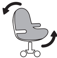
MECANISMO SINCRONIZADO: El respaldo y el asiento se adaptan de forma sincronizada pero en distinto ángulo, a los movimientos de la persona sentada.
