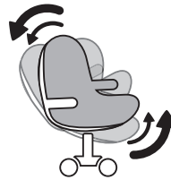
MECANISMO ASINCRONIZADO: El respaldo y el asiento se adaptan de forma independiente a los movimientos de la persona sentada. Permite una mejor adaptación al cuerpo.
